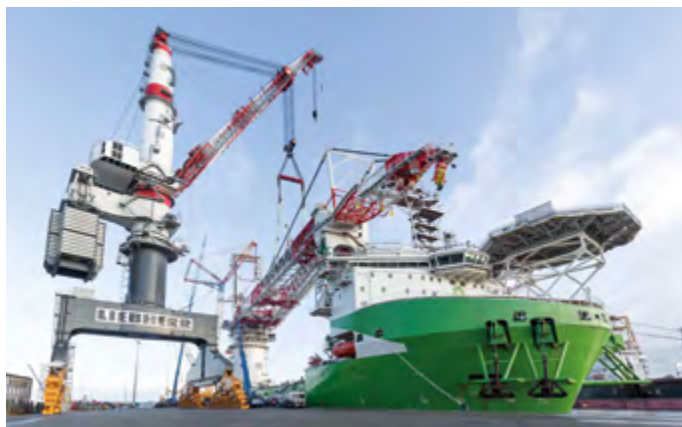
Der 5.000-Tonnen-Krans nach der Montage
