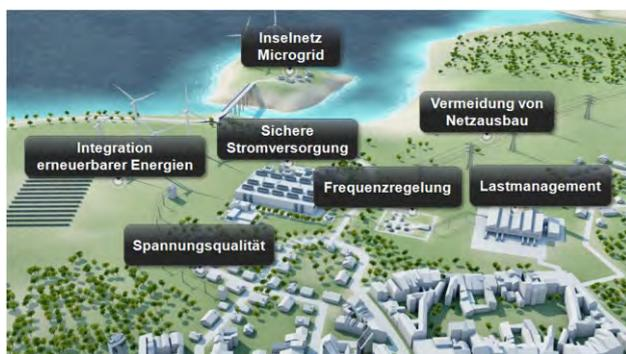
**Bild 1: Einsatzmöglichkeiten elektrischer Energiespeicher in transformierenden Energiesystemen**
