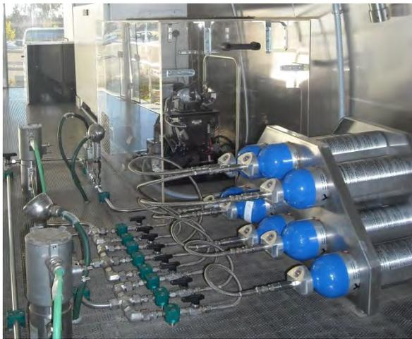
**Bild 1:** 8 Metallhydrid basierte  $\text{H}_2$ -Tankmodule zur Speicherung von per Photovoltaik und Elektrolyse erzeugten Wasserstoffs vor der Rückverstromung (im Hintergrund) © Abengoa Hidrógeno, Sevilla, Spanien (Partner im BOR4STORE Projekt [6])
