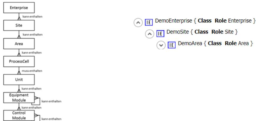
Abbildung 48: Anlagenhierarchie gem. [DIN EN 61512-1] und Beispiel in AutomationML
