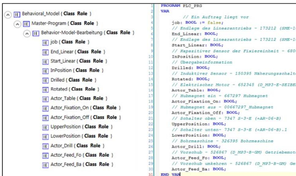
Abbildung 34: Variablenliste aus CoDeSys und ihre Entsprechung in AutomationML
