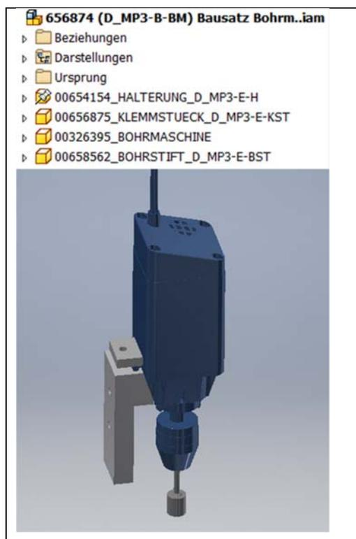
Abbildung 24: Kaufteil Bohrmachine mit Halterung und Darstellung der Stückliste
