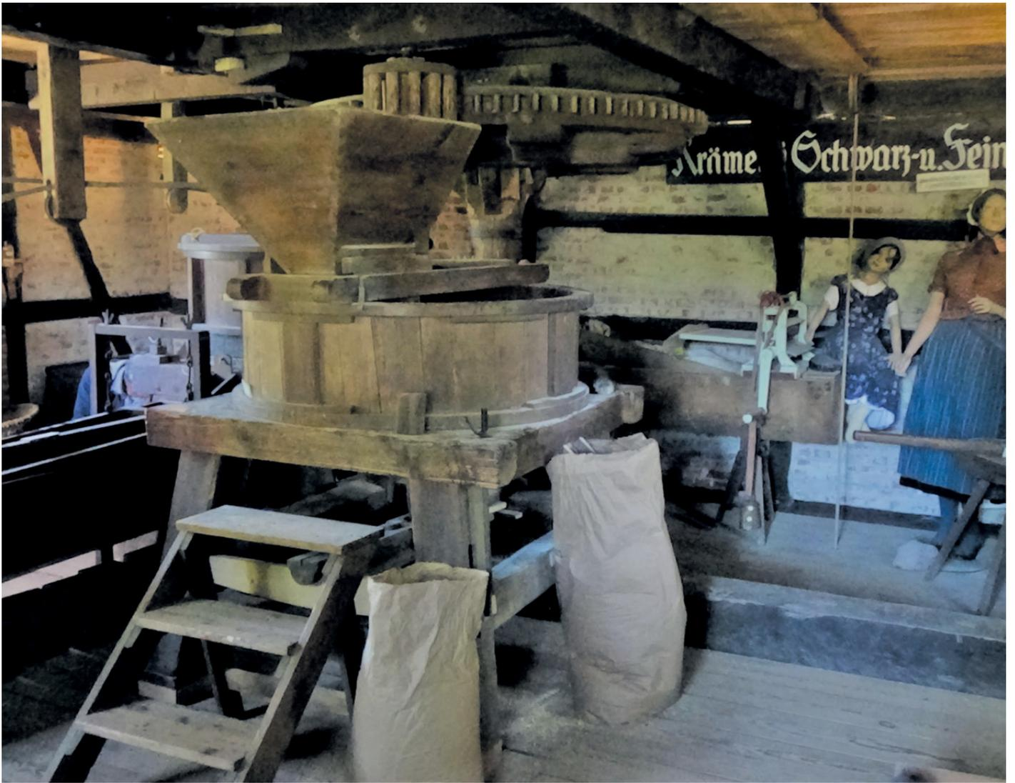
Grütmahlgang mit dahinterliegendem Mehlmahlgang und Teilen der Backstube
