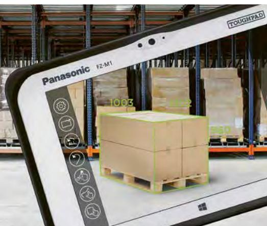
Die optionale integrierbare Real-Sense-Technologie ermöglicht die 3-D-Vermessung von Packstücken und Lagerfläche.
