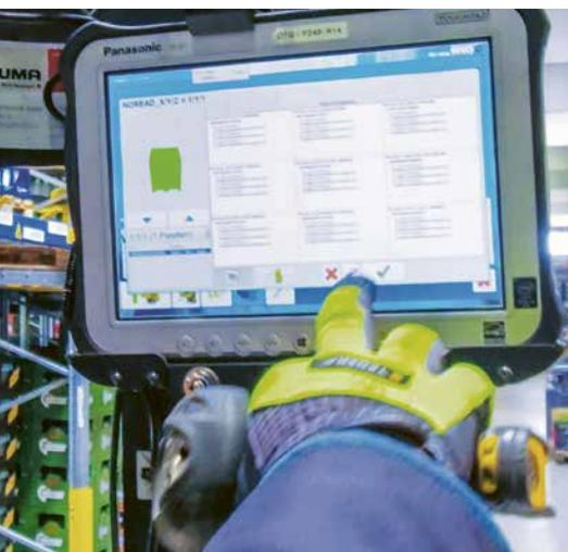
Das mit Arbeitshandschuhen bedienbare Tablet FZ-G1 dient bei Pachmayr als Alternative zum festen Stapler-Terminal.
