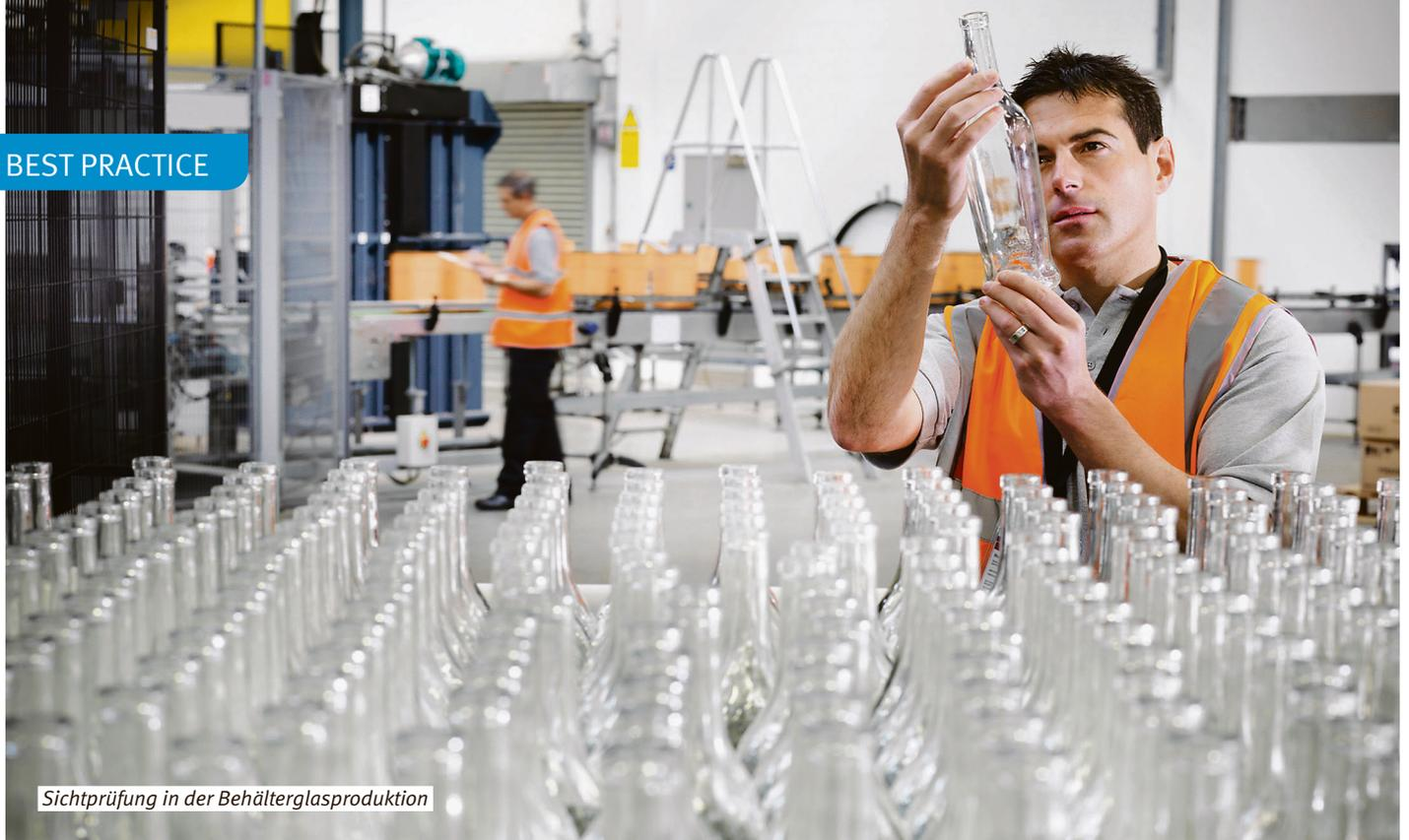
Sichtprüfung in der Behälterglasproduktion
