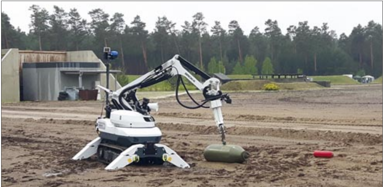
Fernbedient: Beim Entschärfen von Kampfmitteln wird der Manipulator aus sicherer Deckung per Funk gesteuert
