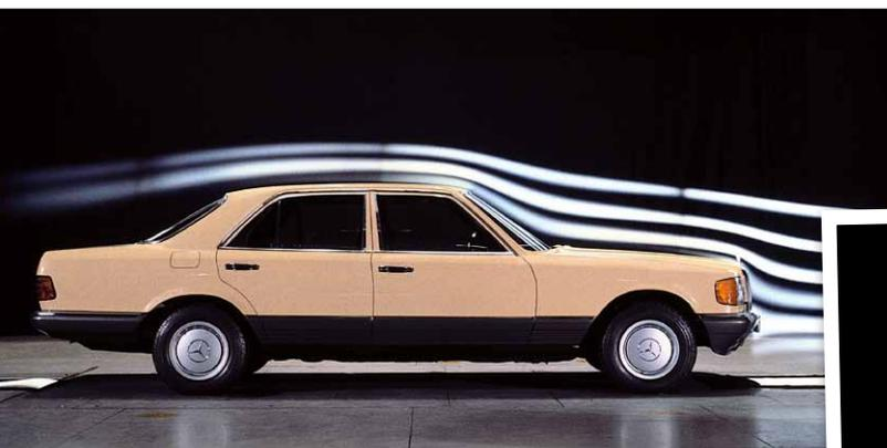
Diese Baureihe ist das erste Mercedes-Benz Serienfahrzeug, das konsequent unter Aerodynamik-Gesichtspunkten entwickelt und gestaltet wird.
