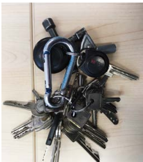
Das im Bodenraum entstandene Luft-Gas-Gemisch geriet durch einen Zündfunken des elektrischen Zugangsschlüssels am Schlüsselbund des Mitarbeiters in Brand.
