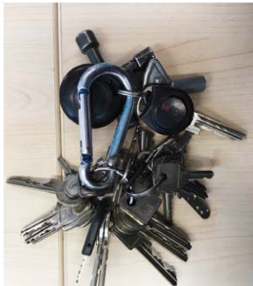
Das im Bodenraum entstandene Luft-Gas-Gemisch geriet durch einen Zündfunken des elektrischen Zugangsschlüssels am Schlüsselbund des Mitarbeiters in Brand.
