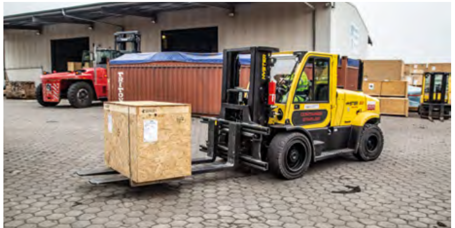
So muss es sein: Viel Platz zum Manövrieren und gut balancierte Ladung
