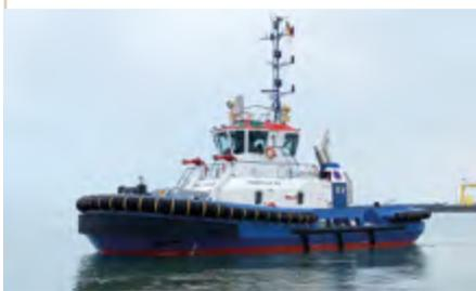
**Hamburg** – Die Hamburger Schleppreederei FAIRPLAY TOWAGE Group hat mit der „FAIRPALY XV“ und dem Taufnamen „Jan“ ein neues Schiff in Betrieb genommen. Es verfügt über 5.000 PS und 70 Tonnen Pfahlzug bei einer Länge von 24 Metern und einer Breite von elf Metern. Die Gruppe bietet nach der Übernahme von BUGSIER vor zwei Jahren nunmehr Schleppdienste in 29 europäischen Häfen an.
