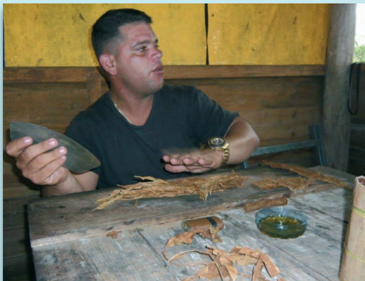
der Tabak wird mit dem Wiegemesser geschnitten
