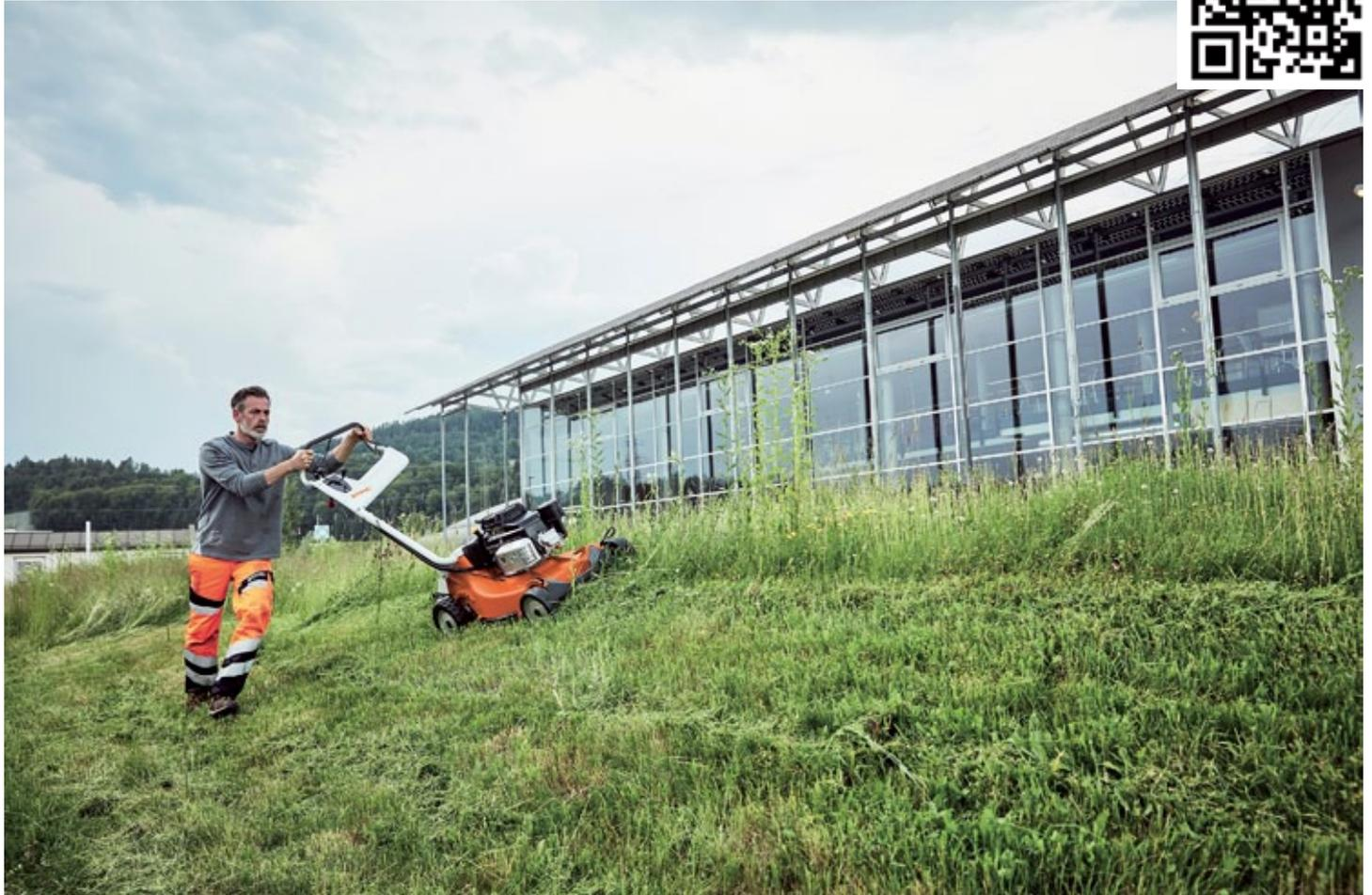
Langlebigkeit, geringes Gewicht, gute Ergonomie – diese Argumente sprechen für die Benzinmäher STIHL RM 756 GC. Mit 54 Zentimeter Schnittbreite ist das Modell für Flächen bis 3.000 Quadratmeter ausgelegt. (Foto: STIHL)
