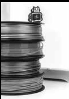
Im 3Dspace kann man zwischen den Materialien PLA und ABS wählen. PLA ist ein überwiegend biologisch abbaubarer Kunststoff, der aus nachwachsenden Rohstoffen – wie Maisstärke und Zuckerrohr – hergestellt wird. ABS hingegen besitzt eine hohe Festigkeit und ist kratzfest. Das Spielzeugauto wurde mit orangefarbenem PLA gedruckt.
