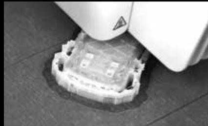
Ohne Supportmaterial geht es nicht. Das weiße Material, das den kleinen VW Beetle umgibt, unterstützt den Druck. Ohne dieses Material müsste die Bodenplatte des Autos in der Luft gedruckt werden. Aber keine Sorge: Legt man das Fahrzeug nun 24 Stunden in ein Wasserbad, löst sich das weiße Material auf und der orange-farbene VW Beetle kommt zum Vorschein.
