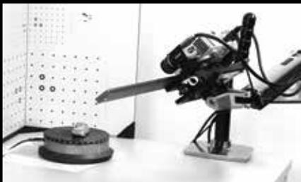
Reale Objekte, hier einen VW Beetle, in ein 3D-Modell umwandeln: Ein Scanner visualisiert das Fahrzeug und sendet die Daten weiter an den PC.
