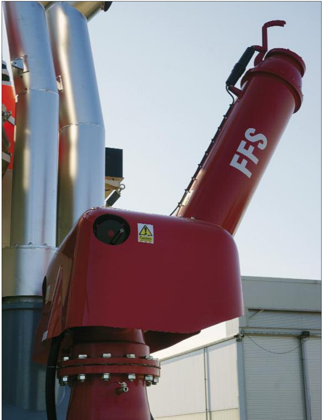
Geballte Kraft: Einer der drei großen Wasserwerfer der „Branddirektor Westphal“ – er kann bis zu 180 Meter weit und 110 Meter hoch spritzen. Die drei Pumpen schaffen bis zu 120.000 Liter Löschwasser pro Minute_Seite 30
