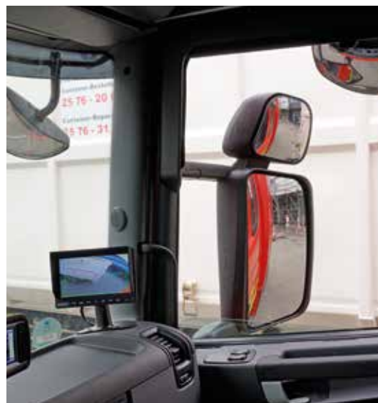
Innenansicht des Abbiegeassistenten | Foto: Julia Kühl
