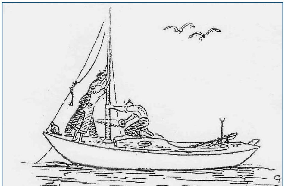
schwöör“ und hatte alsbald etwas präpariert. Für seinen Mast – unten kreisrund – ließ er sich zwei verzinkte Stahlrohrstücke machen mit je einem Flansch daran. Und beide Teile waren mit einem Scharnier zum Umklappen nach achtern ausgestattet. Diese Simplekonstruktion nun in der richtigen Höhe über dem Kajütendach am Mast einzusetzen, war das Problem. Alles abzubauen und den Mast zu ziehen, erschien uns viel zu aufwändig. Wozu hatte er
