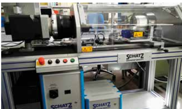
Abb. 6: Reibwertprüfstand für metrische Schraubenverbindungen von M5 bis M24
