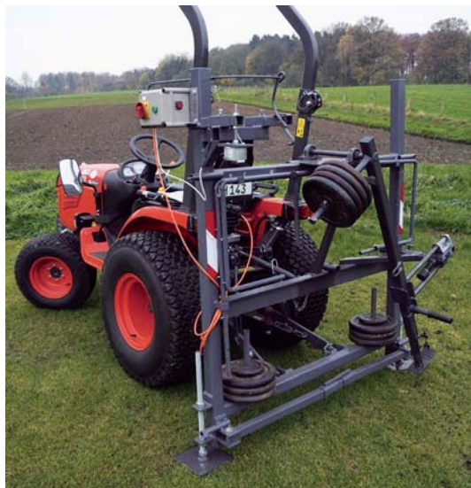
Prototyp des mobilen Divot-Makers „Oснаfoot“ in der Dreipunkthydraulik des Pflegeschleppers. (Foto: LAWSON, 2017)
