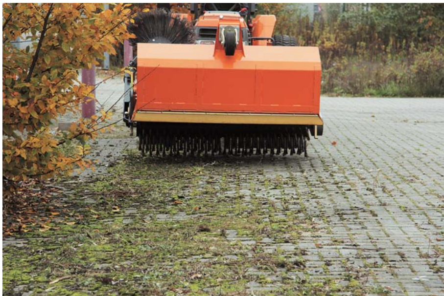
Spezialausrüstung für die bema Kehrmaschine: bema Wildkrautbürste (Fotos: bema GmbH Maschinenfabrik)
