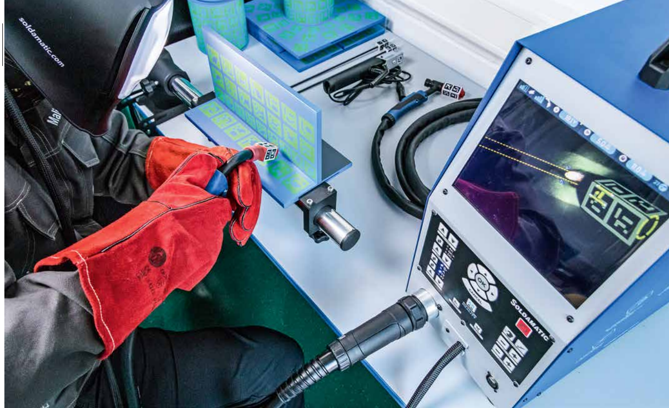
Virtuelles MAG-Schweißen einer Kehlnaht als typische Standardschweißaufgabe.
