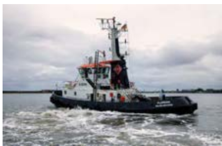
Die Kleine. Die 30 Meter lange „Florian“ überzeugt mit 32 Tonnen Pfahlzug.
