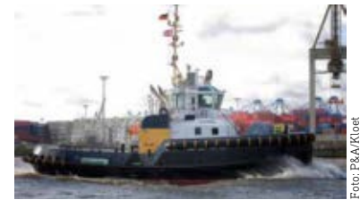
„Michel“. Der jüngste Schlepper ist mit 80 Tonnen Pflanzzug zugleich der stärkste.
