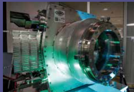
Der für den European XFEL maßgeschneiderte Adaptive Gain Integrating Pixel Detector (AGIPD) macht die schnellsten Röntgen-Serienbilder der Welt.
