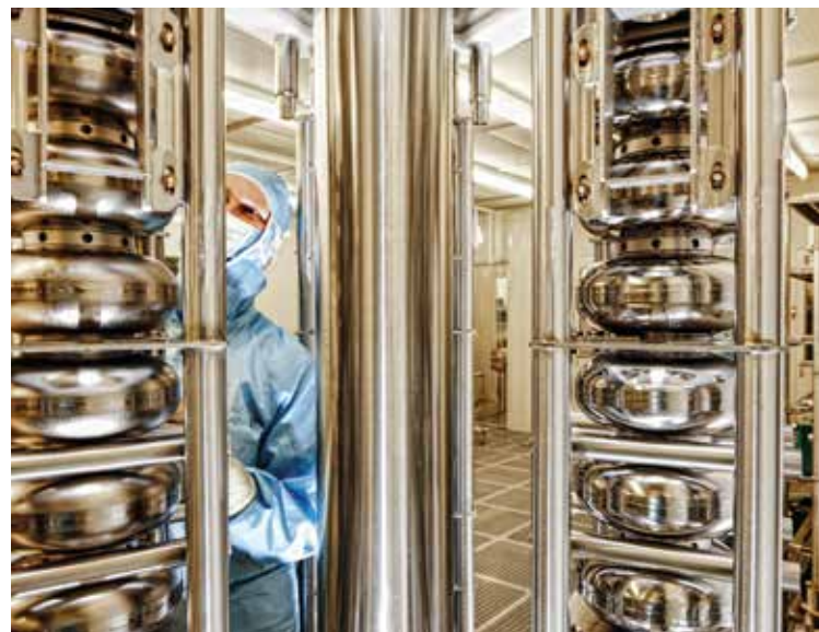
Supraleitende Resonatoren aus dem Metall Niob bringen Teilchen unter anderem in FLASH und im Röntgenlaser European XFEL auf Touren.
