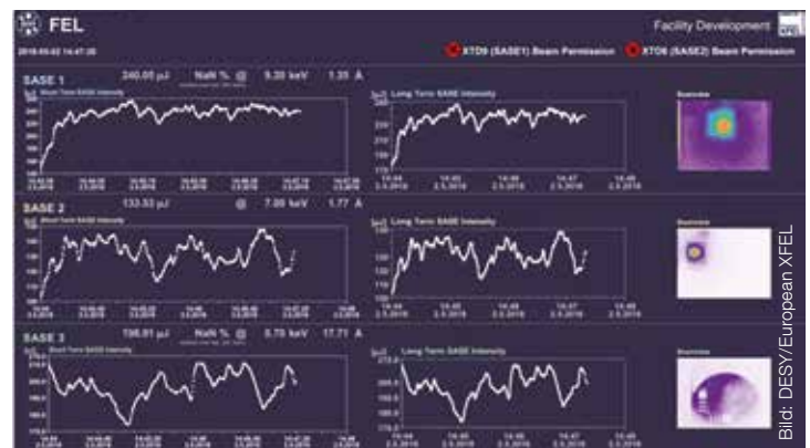
Der Monitor im Beschleunigerkontrollraum zeigt alle drei Röntgenlaserstrecken des European XFEL im Parallelbetrieb.
