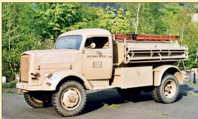
Opel-Blitz Tanklöschfahrzeug TLF 15, Baujahr 1944. Der Löschwassertank fasste 2.500 l, die Feuerlöschkreiselpumpe FP hatte eine Leistung von 1.500 l/min bei 8 bar.
