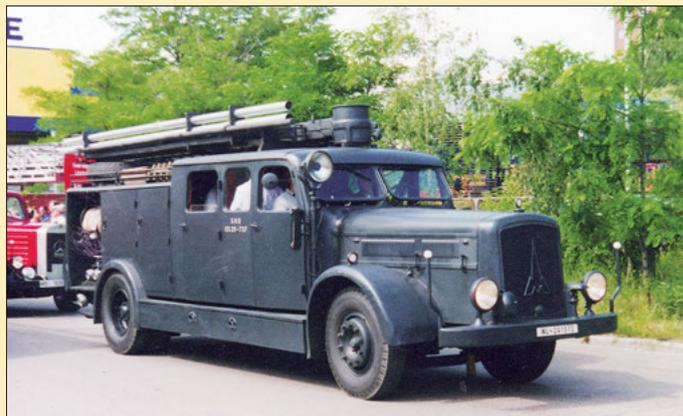
Magirus-Kraftfahrtspritze KS 25 des SHD. Der Löschwassertank fasste 300 Liter, zusätzlich konnten 80 Liter Schaummittel mitgeführt werden. Das Fahrzeug verfügte über eine Feuerwehrpumpe PH 125 L, die 2500 Liter Wasser in der Minute fördern konnte.
