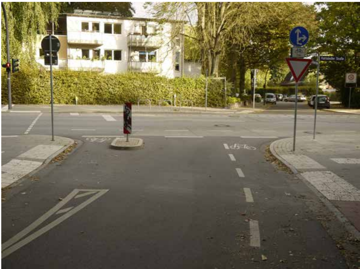
Bild 40: Wilhelm-Grimm-Straße / Rahlstedter Straße (Veloroute 7), für Radverkehr in Gegenrichtung freigegebene Einbahnstraße
