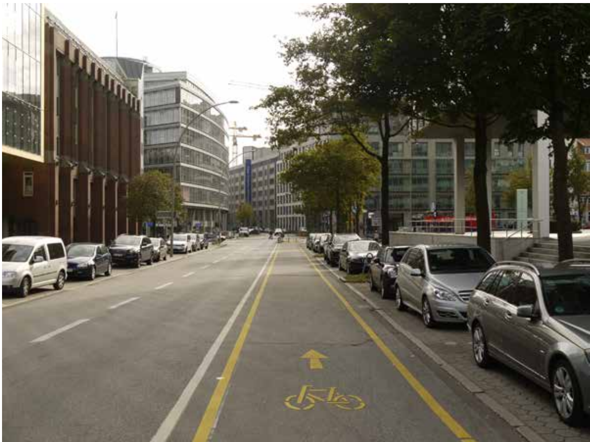
Bild 74: Caffamacherreihe, provisorischer Radfahrstreifen entgegen der Einbahnstraße
