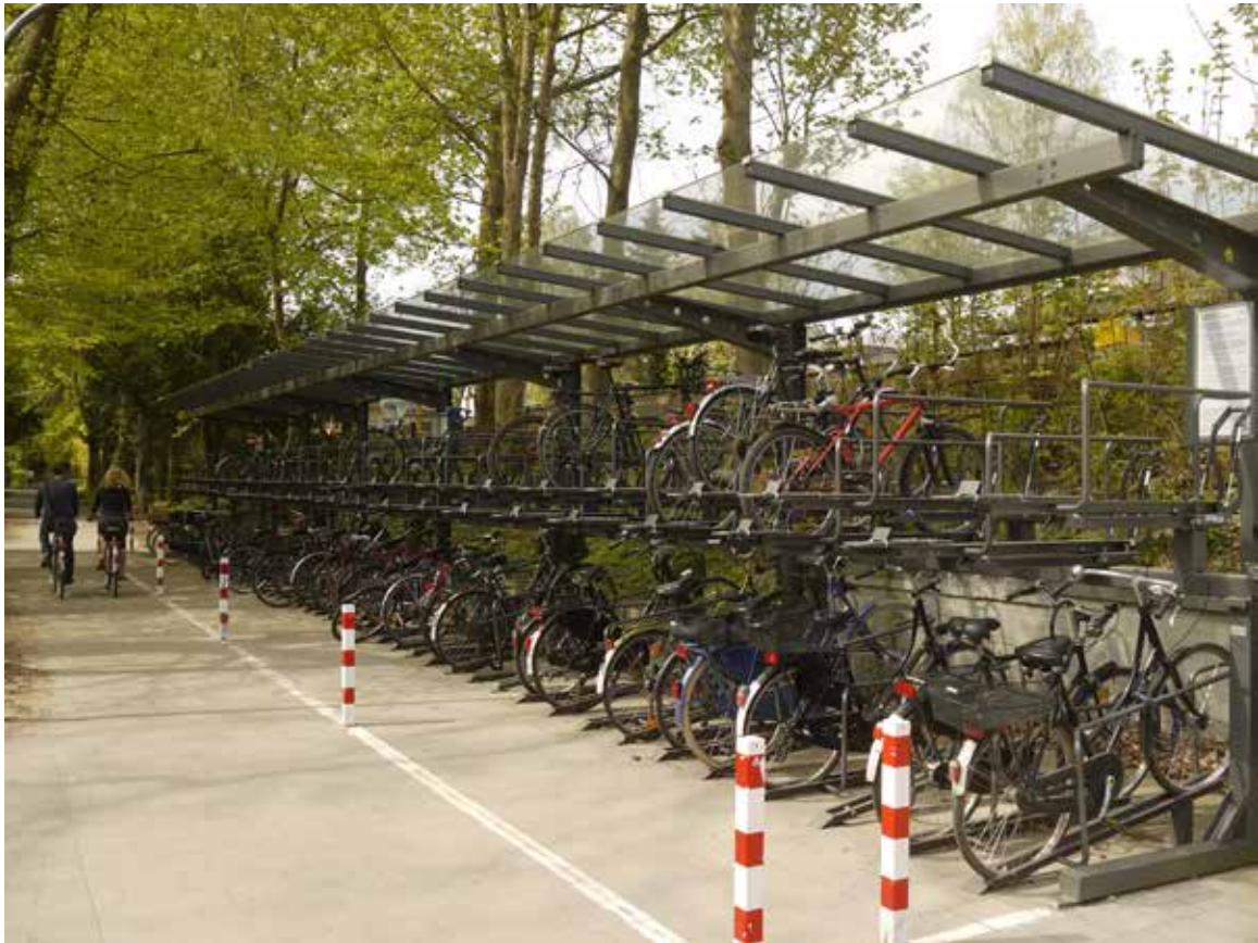
Bild 177: Bike+Ride-Anlage S-Bahn-Haltestelle Othmarschen, überdachte Doppelstockparker
