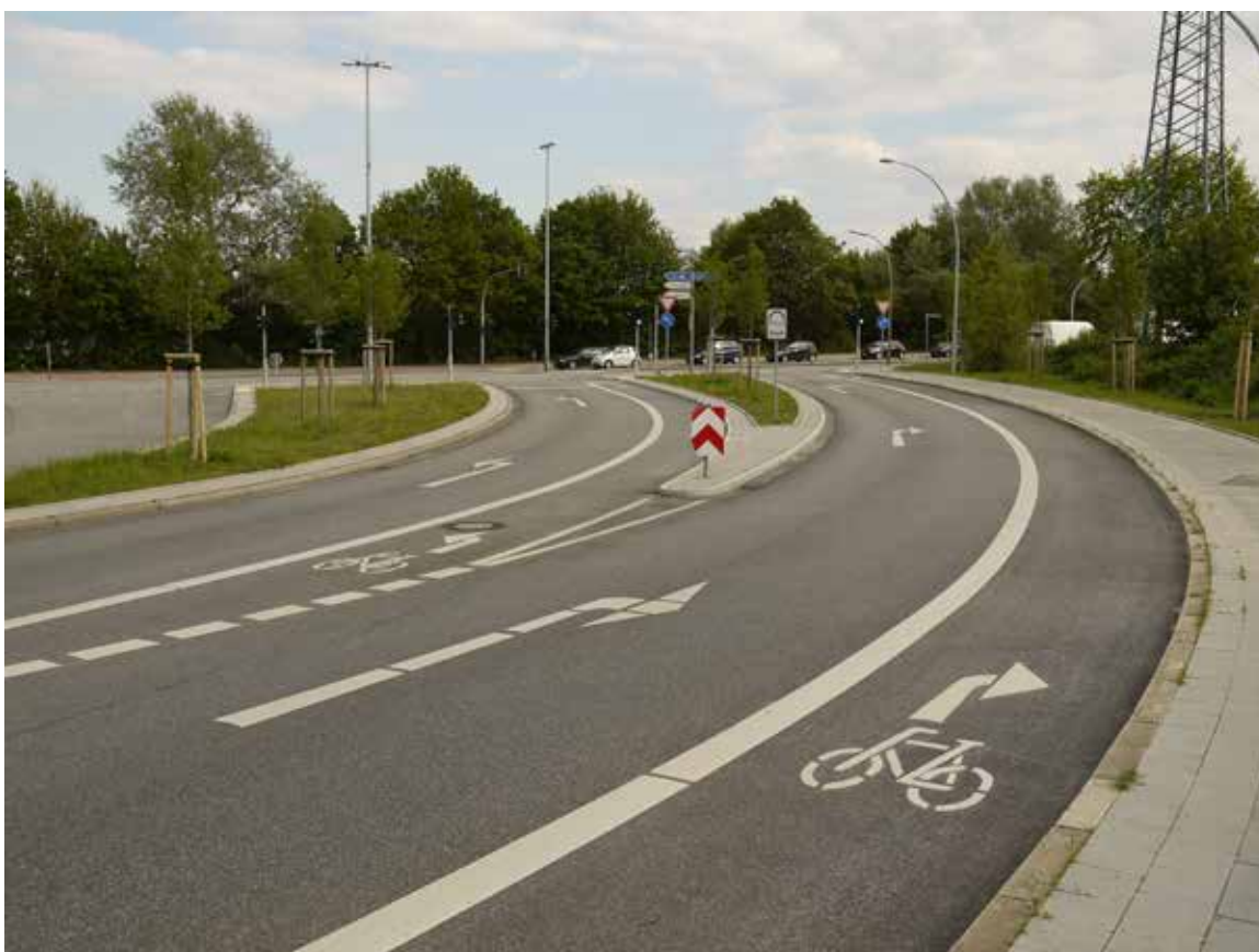
Bild 54: Ausschläger Allee (Veloroute 9) / Grusonstraße, Radfahrstreifen für links und für rechtsabbiegenden Radverkehr
