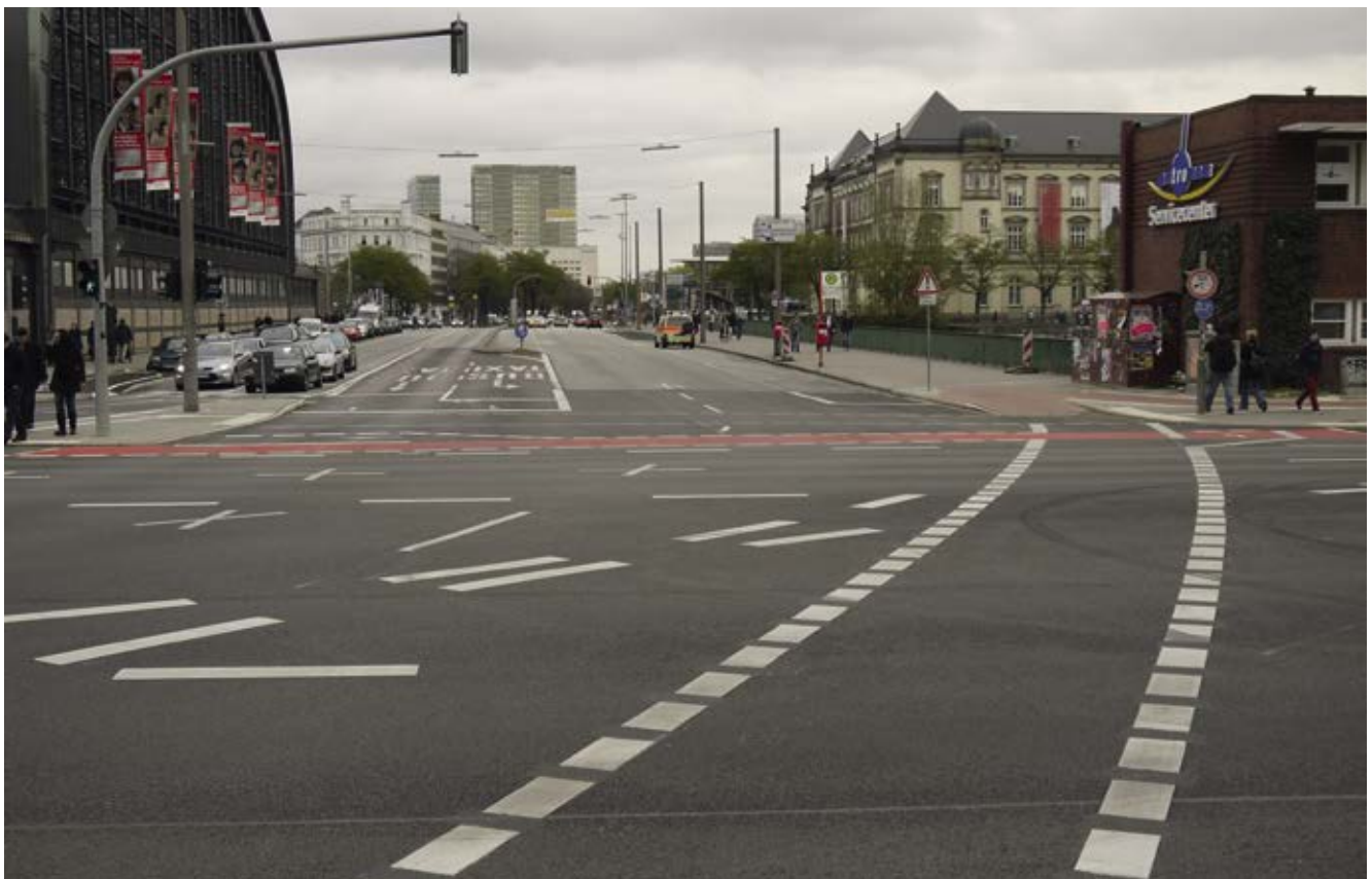
Bild 18: Steintorwall / Steintordamm (Velorouten 7, 8, 9), direkte Radverkehrsführung und „Berliner Lösung“ ohne Konflikte mit wartenden Fußgängern
