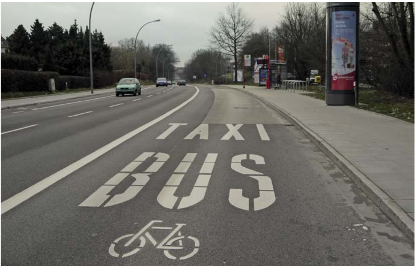
Bild 100: Winsener Straße (östliche Straßenseite), Busfahrstreifen mit Freigabe für den Radverkehr
