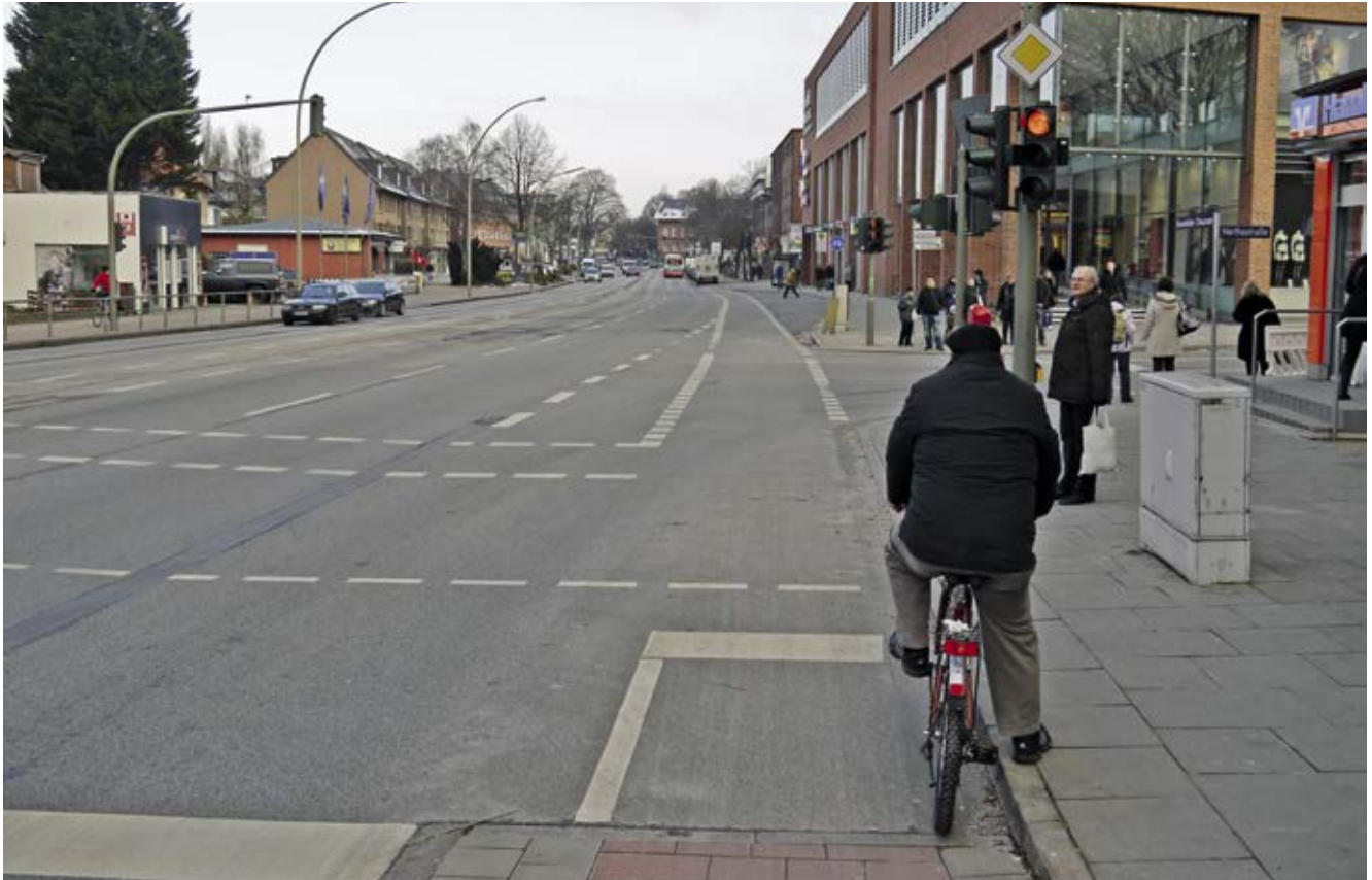
Bild 69: Bramfelder Chaussee / Herthastraße (Einkaufszentrum Bramfeld), geradlinige Radverkehrsführung und „Berliner Lösung“ ohne Konflikte mit wartenden Fußgängern, direkt anschließend Radfahrstreifen ohne Konflikte mit Busfahrgästen
