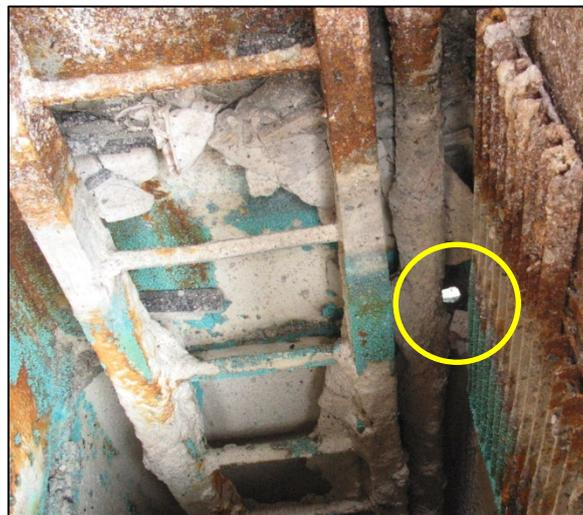
Abbildung 33: Durchrostung im Schacht der Raumleiter Backbordseite, hier Schott von Laderaum 3 zu Laderaum 2
