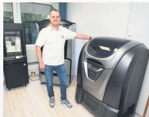
Das neue Mitglied der ProTec-3D-Familie: Mirco Schulz zeigt den Drucker, der sowohl mit Acryl als auch mit Flüssig-Silikon arbeitet und hochpräzise Bauteile auf in kleinsten Formaten ermöglicht.
