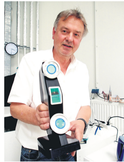
Mit diesem Hand-Scanner lassen sich die Daten von bis zu acht Meter langen Objekten erfassen.
