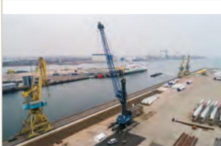
**Rostock** – Liebherr hat seinem Nachbarn Euroports den ersten von zwei Hafenmobilkränen geliefert. Beide Firmengelände liegen nur 500 Meter im Rostocker Hafen entfernt. Der komplett montierte Kran wurde mit einem Schwerlastschiff über die kurze Strecke an den Pier transportiert. Dort soll er den Stückgutumschlag weiter verstärken. Der LHM 550 hat eine Reichweite von 54 Metern und kann bis zu 144 Tonnen heben. Ein baugleiches Modell soll in diesem Herbst folgen.
