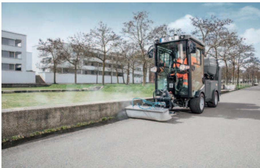
Mit dem WRS 200 präsentiert Kärcher ein neues Anbaugerät für Kommunalmaschinen, das Hochdruckanwendungen mit kaltem und heißem Wasser ermöglicht.
