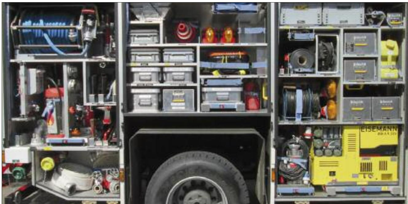
**Beladung Beifahrerseite:** Vom Notstromaggregat bis zum formstabilen Schnellangriffsschlauch ist alles on board. Für First-Responder-Einheiten auch mit Defibrillator und Beatmungsmodul
