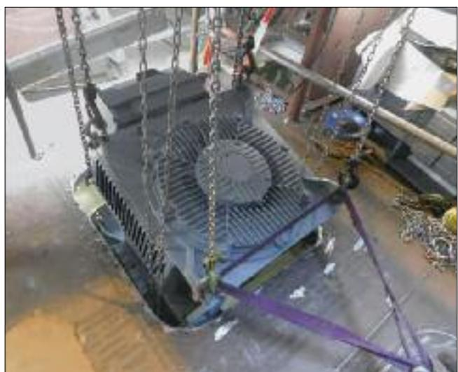
**Maßarbeit:** Einer von insgesamt drei baugleichen Feuerlöschdieselmotoren wird in den Maschinenraum des neuen Löschboots abgesenkt\_Seite 18
