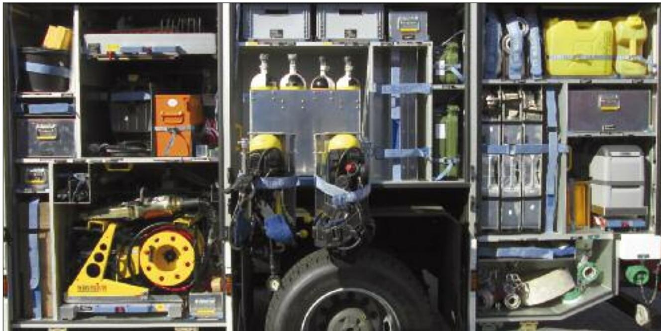
**Beladung Fahrerseite:** Nur das Schlauchboot fehlt, ansonsten verfügt das HFL 20 über die gleiche Ausrüstung wie bei der Berufsfeuerwehr, inklusive Weber-Hydraulik
