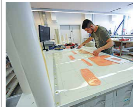
Flexoklischees: Mit den Druckformen lassen sich Kartons bedrucken
