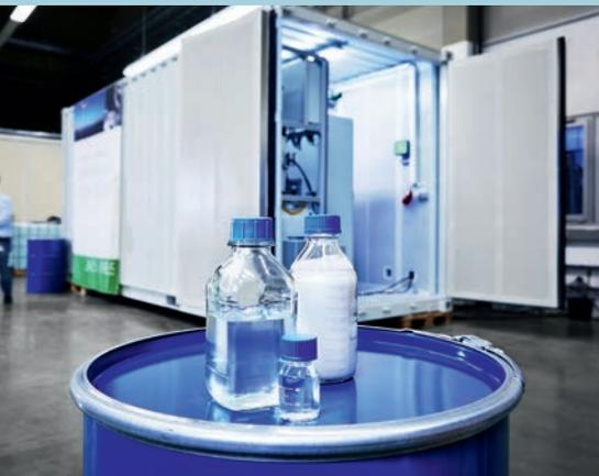
Dieser Container erzeugt aus grünem Strom, Luft und Wasser synthetische Kraftstoffe.
