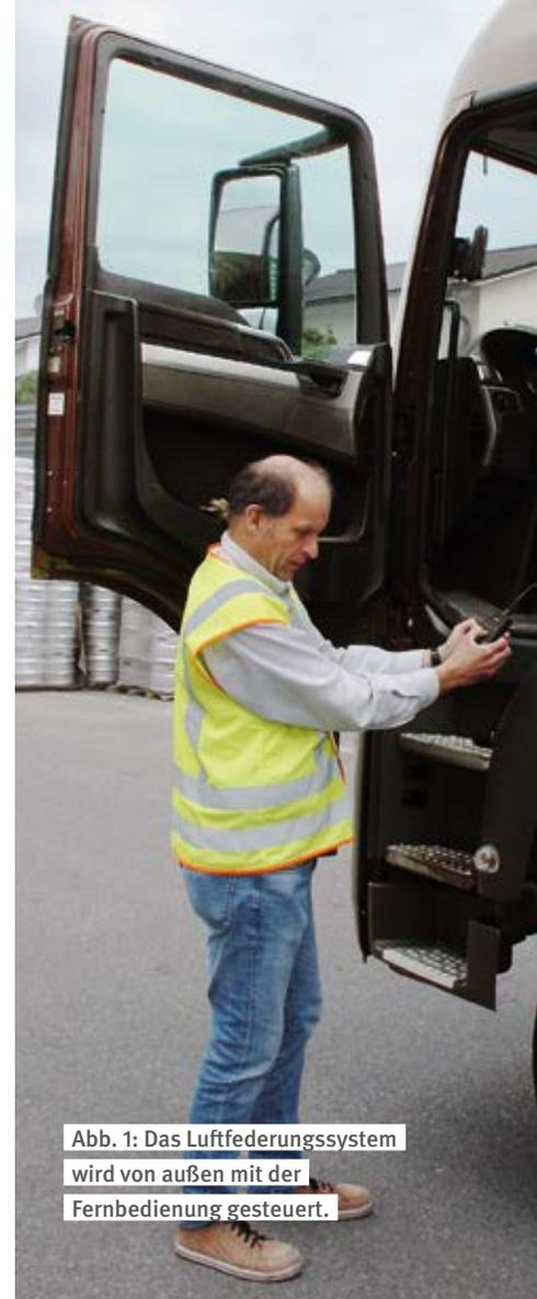
Abb. 1: Das Luftfederungssystem wird von außen mit der Fernbedienung gesteuert.
