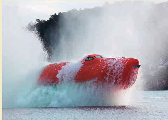
3.6 > Rettungsboot im Härtestest: Gemäß SOLAS-Konvention müssen Rettungsboote bestimmten Prüfungen unterzogen werden. Dazu gehört auch der Drop Test, bei dem ein Rettungsboot mit voller Beladung aus mehreren Metern aufs Wasser fällt.
