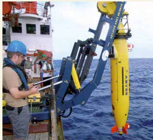
2.29 > Ein Mitarbeiter eines Forschungsschiffs setzt ein autonomes Unterwasserfahrzeug (AUV) ins Meer, das mit Sensoren bestückt ist.
