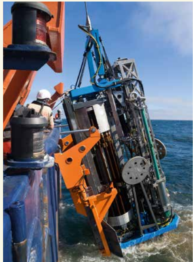
3.10 > Das Unterwassergerät MARUM-MeBo wird seit mehreren Jahren für Bohreinsätze am Meeresgrund genutzt. Es lässt sich flexibel auf verschiedenen Forschungsschiffen einsetzen. Mit ähnlichen Geräten könnten künftig Methanhydrate abgebaut werden.
