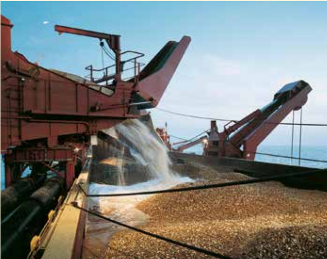
2.8 > Vor der niederländischen Insel Ameland fördert ein Saugbagger Sand vom Grund der Nordsee, mit dem der Inselstrand verbreitert werden soll.
