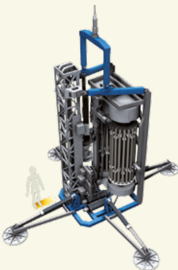
3.10 > Das Unterwassergerät MARUM-MeBo wird seit mehreren Jahren für Bohreinsätze am Meeresgrund genutzt. Es lässt sich flexibel auf verschiedenen Forschungsschiffen einsetzen. Mit ähnlichen Geräten könnten künftig Methanhydrate abgebaut werden.
