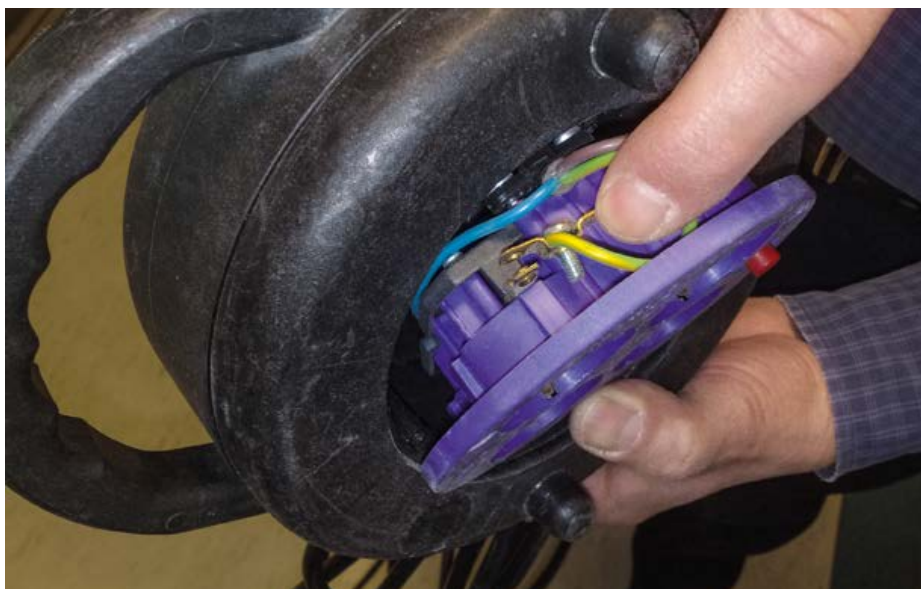
Ein gelöster Schutzleiter in einem Leitungsroller kann nur durch die regelmäßige messtechnische Kontrolle und Funktionsprüfung durch eine Elektrofachkraft erkannt werden.
