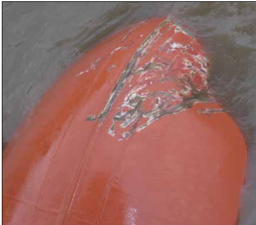
Abbildung 8 Beschädigung Bugwulst CORAL IVORY
