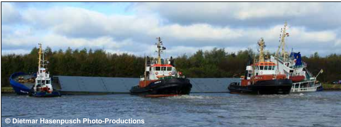
© Dietmar Hasenpusch Photo-Productions Abbildung 4: Stabilisierung der SIDERFLY an der Kanalböschung
