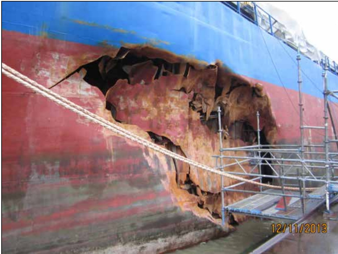
Abbildung 9: Loch im Schiffsrumpf der SIDERFLY (Backbordseite)
