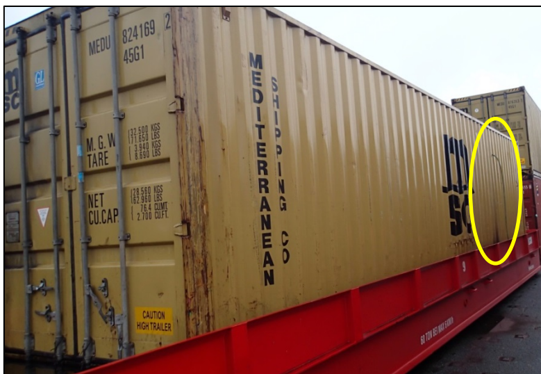
Abbildung 7: Brandbetroffener Container mit Fognail und Schlauch
