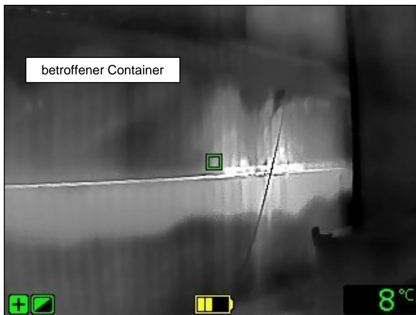
Abbildung 15: Temperaturmessung der Feuerwehrröhre auf der Stb-Seite des Stapels: 8 °C
