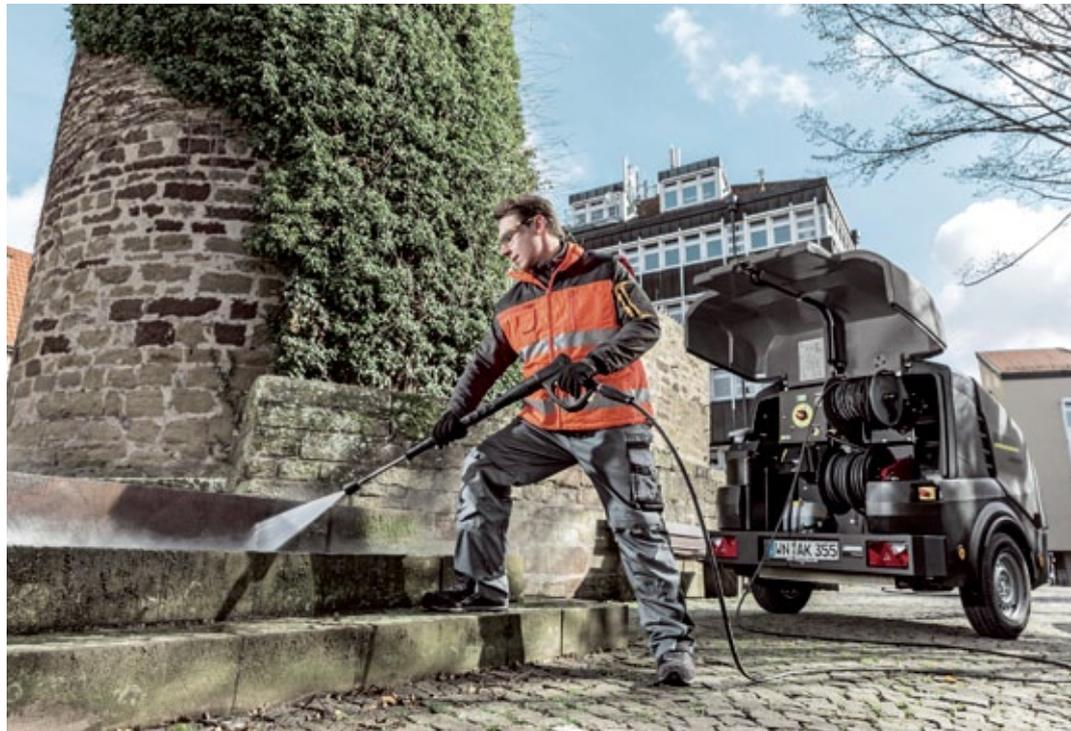
Für hartnäckigste Fälle: Heißwasserreinigung mit Hochdrucktrailer.
