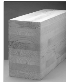
Abb. 1: Horizontal verleimte Brettschichtholz-Lamellen
