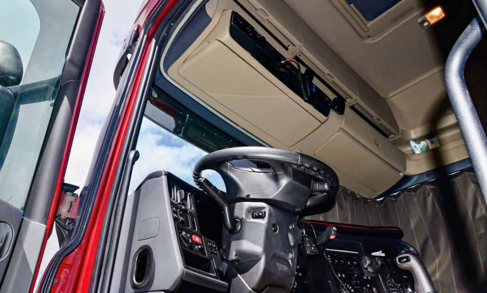
Bisher sind Tachografen in Lkw ab 3,5 Tonnen vorgeschrieben (hier am Dach eingebaut), abgesehen vom Nahbereich um den eigenen Betrieb. Im grenzüberschreitenden Verkehr soll die Gewichtsgrenze nach dem Willen des EU-Verkehrsausschusses nun auf 2,4 Tonnen abgesenkt werden.
