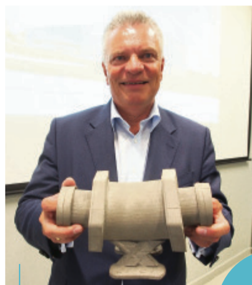
Prof. Dr. Claus Emmelmann zeigt den Einfüllstutzen für das Militärflugzeug A400M. Gedruckt ist es halb so teuer wie konventionell gefertigt. Fotos: Wolfgang Becker
