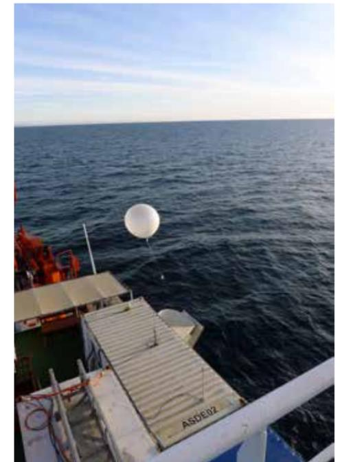
▲ Automatischer Start einer Radiosonde von einem Schiff
