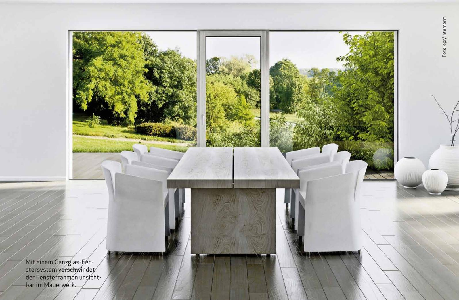
Mit einem Ganzglas-Fenstersystem verschwindet der Fensterrahmen unsichtbar im Mauerwerk.
