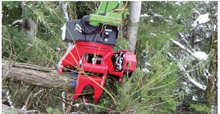
Sicherer Griff: Stämme bis 53 cm Durchmesser packt der KINSHOFER Fällgreifer KM 634-0,25-3Z mit seinen drei Fingern kraftvoll (13 kN) und legt sie problemlos ab. (Foto: Kinshofer GmbH)
