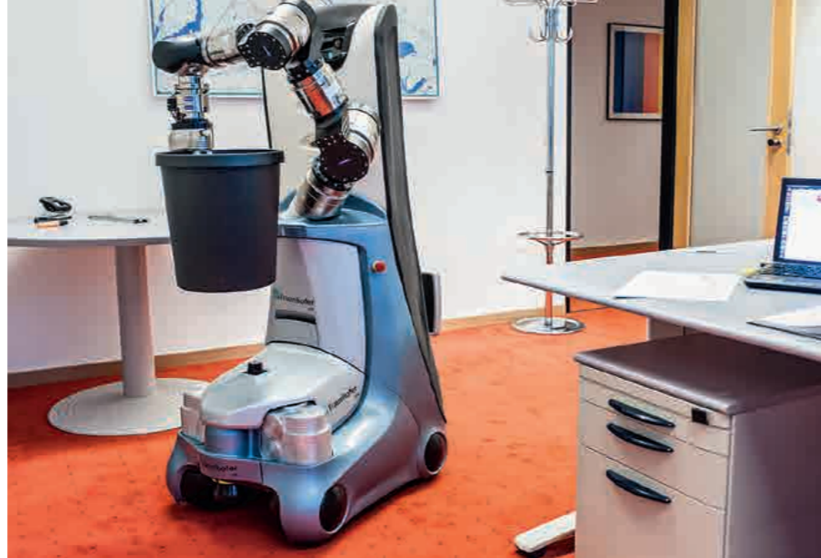
Die ersten autonom agierenden Reinigungsmaschinen wie der vom Fraunhofer-Institut für Produktionstechnik und Automatisierung entwickelte „Care.-0.-Rob“ sind schon im Tagesgeschäft im Einsatz.
