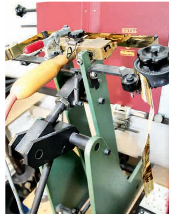
Maschinelle Unterstützung: Die Maschine prägt Schrift auf dem Buchdeckel.
