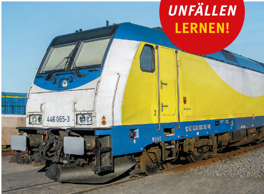
Die Diesellok verfügt über Haltestangen beidseitig der Tür.
